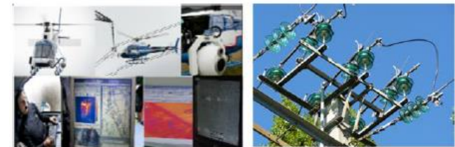
Contrôle des lignes par mission héliportée 2 opérateurs / Drone de visée des isolateurs verre (photo drone Alérion)
